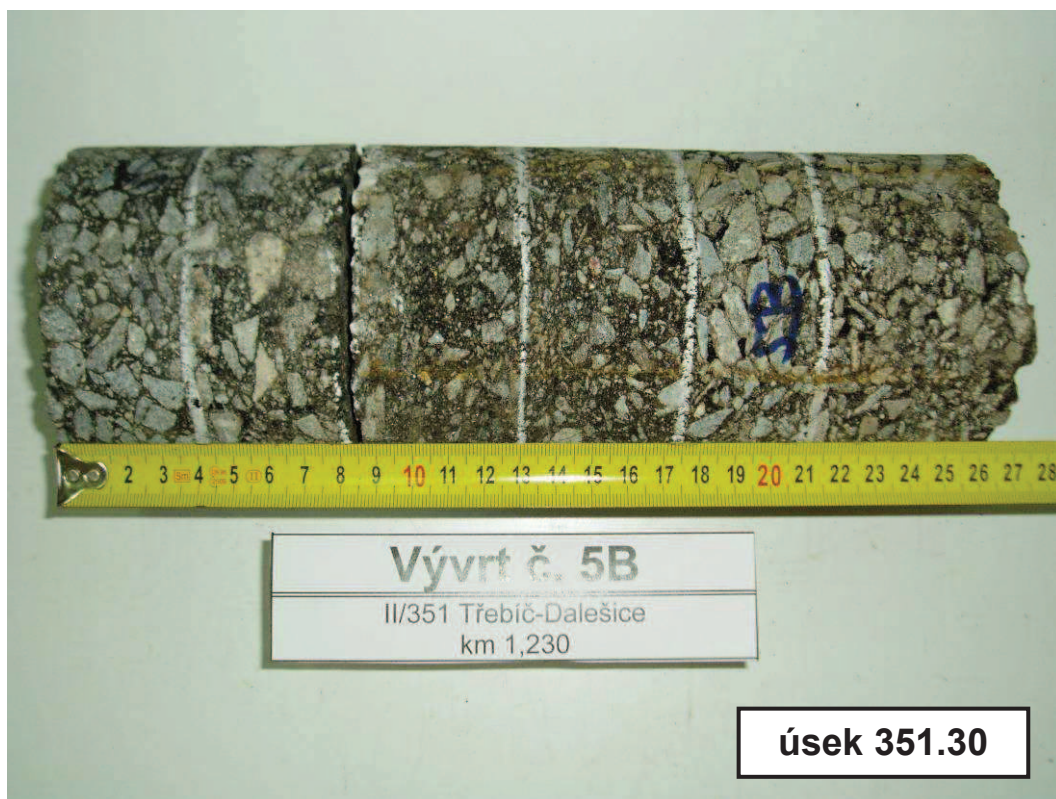
Foto č. 5 – Detail vývrtu č. 5B
