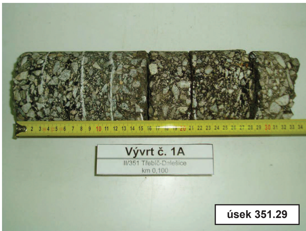
Foto č. 1 – Detail vývrtu č. 1A
