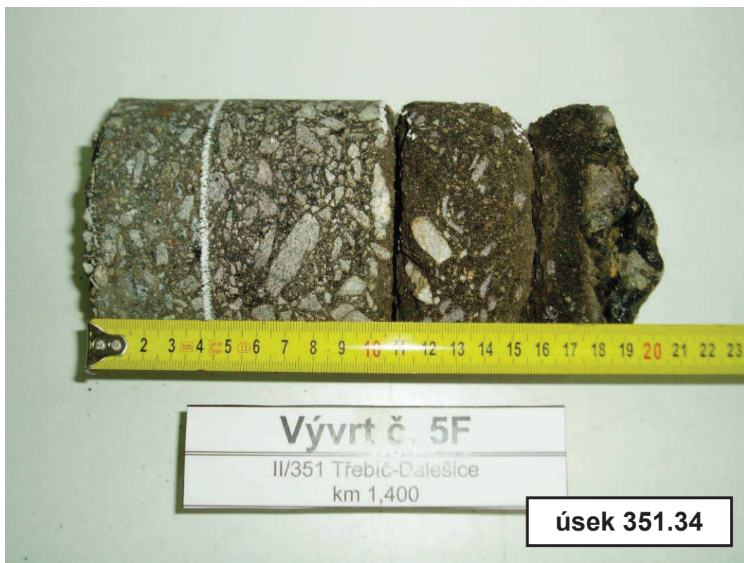
Foto č. 5 – Detail vývrtu č. 5F
