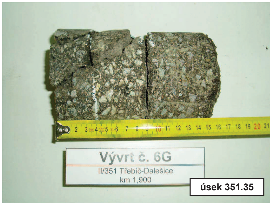
Foto č. 6 – Detail vývrtu č. 6G
