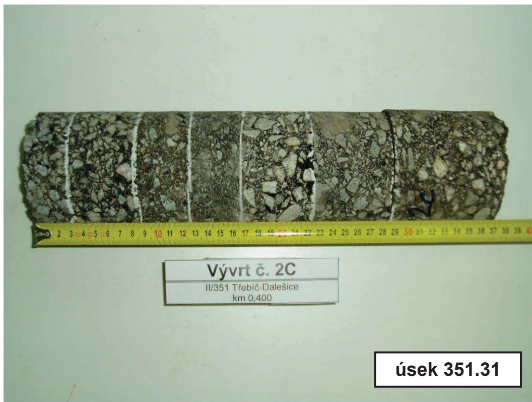
Foto č. 2 – Detail vývrtu č. 2C
