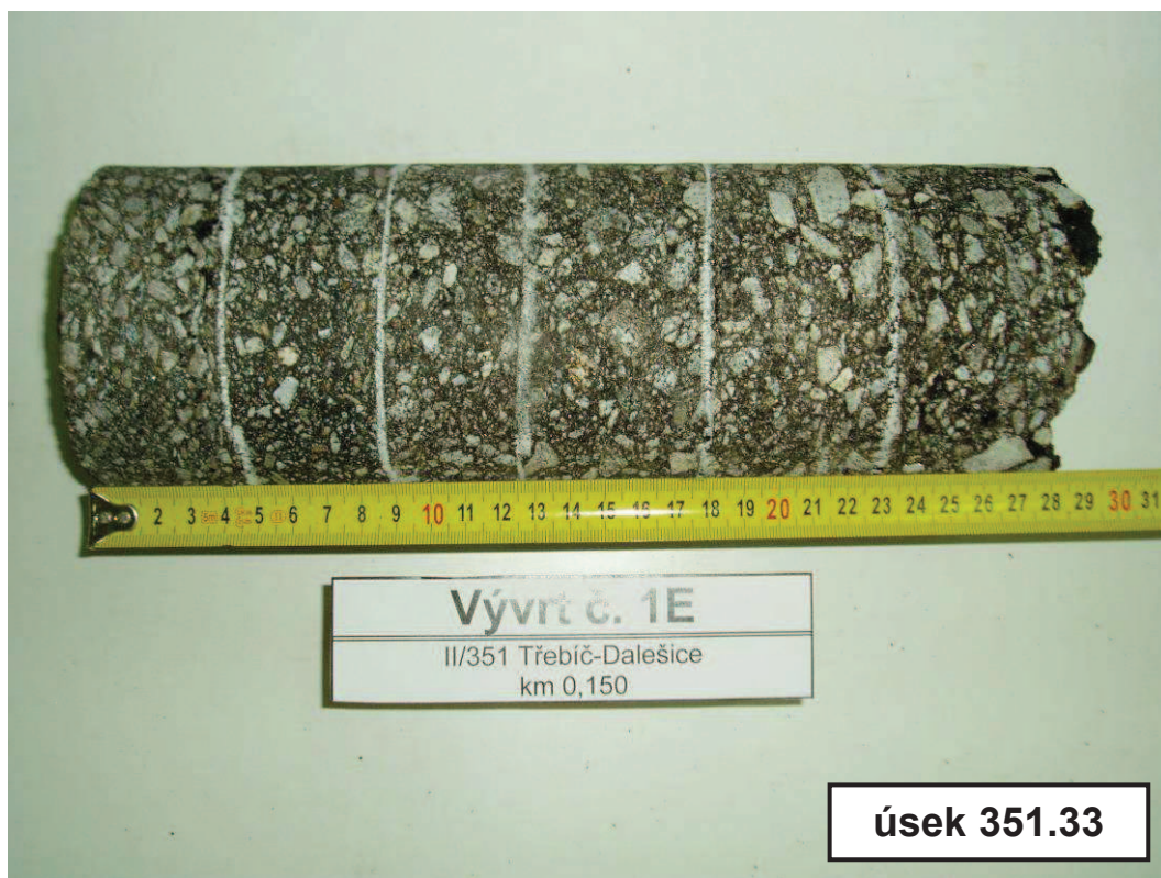
Foto č. 1 – Detail vývrtu č. 1E
