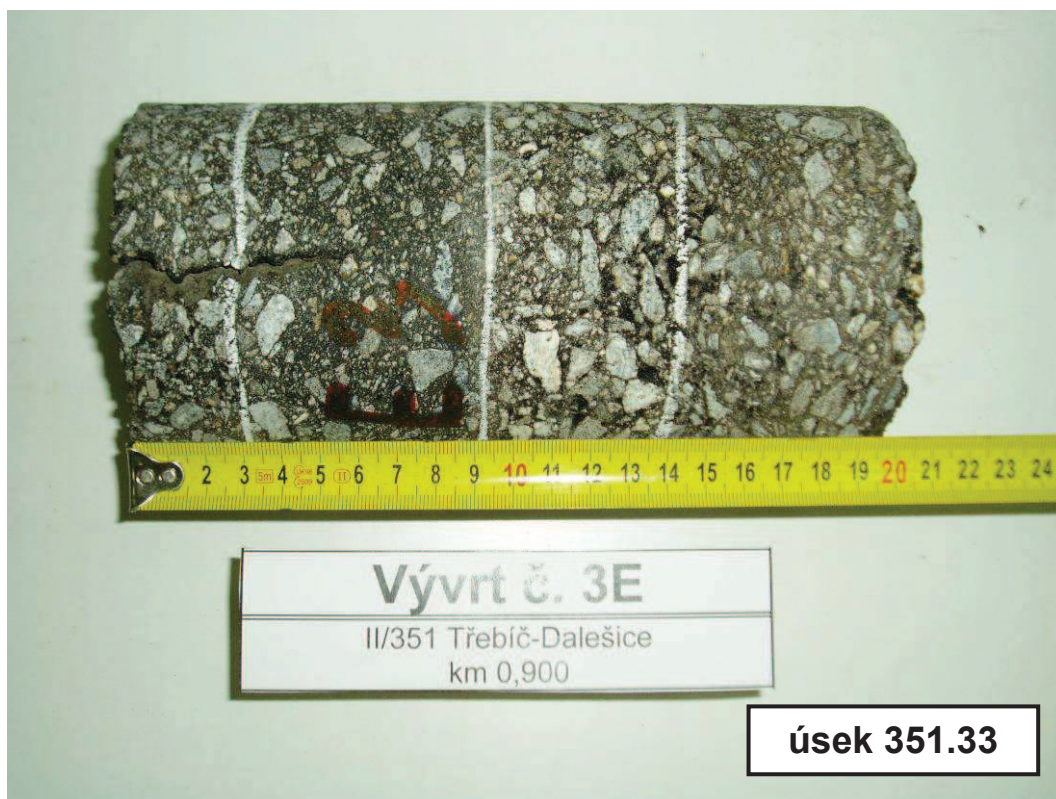
Foto č. 3 – Detail vývrtu č. 3E
